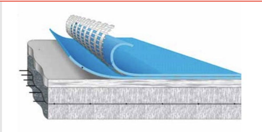
Reinforced PVC Membrane Floor Lining Recubrimiento de piso con membrana reforzada de PVC
